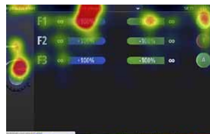
Les mouvements des yeux des conducteurs en train d'utiliser SmartTouch ont été étudiés au scanner. Le scanner a notamment permis de voir si les utilisateurs trouvaient la fonction qu'ils cherchaient et s'ils comprenaient les pictogrammes.
