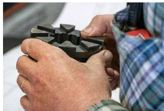
Des réalisations sur mesure, telles que cette pièce de transmission, sont effectuées sur place.
