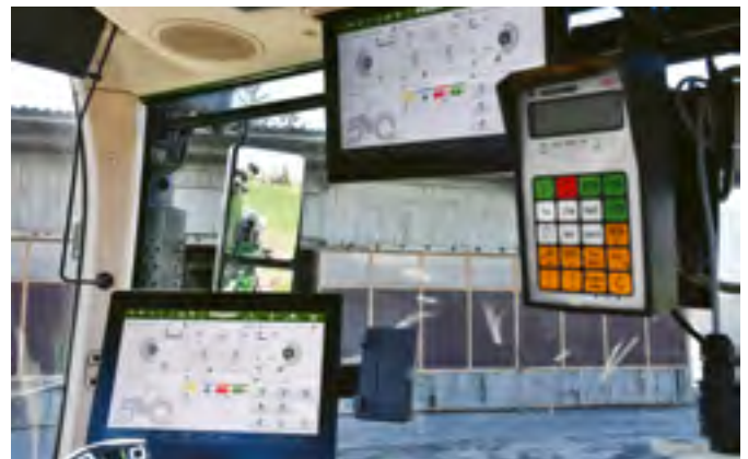
Les outils compatibles Isobus rendent superflus les terminaux d'autres marques. Les tâches sont assurées par le terminal du toit.
