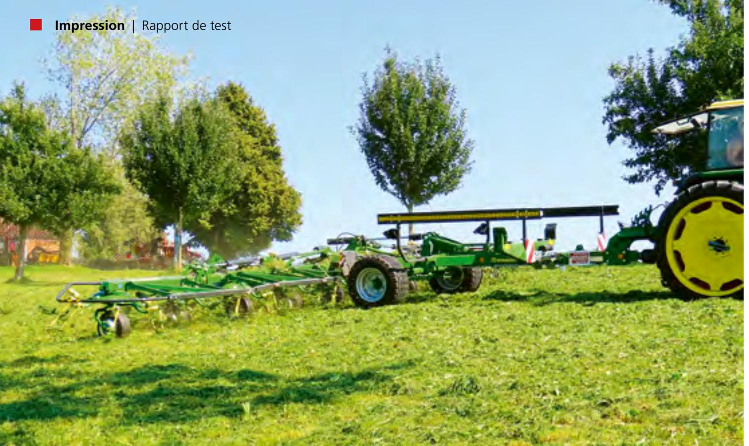
En dépit du diamètre de 150 cm des rotors, le suivi du terrain de la faneuse rotative «Vendro C 1120» est parfait, même sur sol irrégulier.
