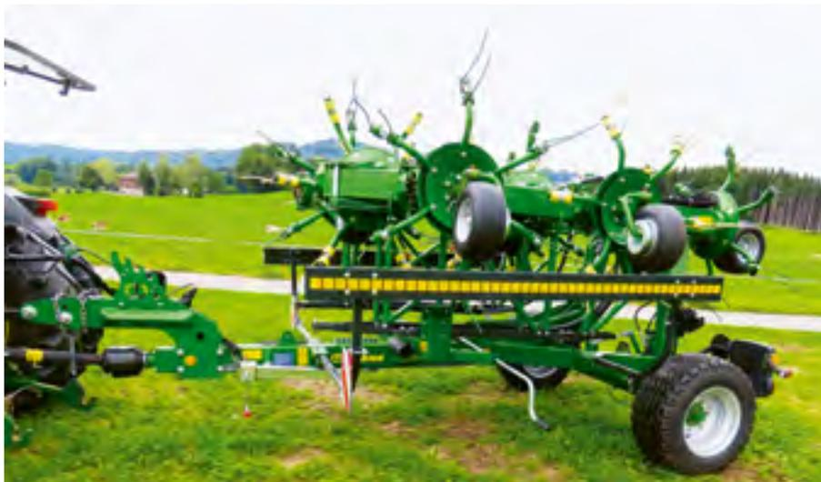
Grâce à un système de repliage sophistiqué, la faneuse de 11,2 mètres peut être ramenée à un ensemble compact.
