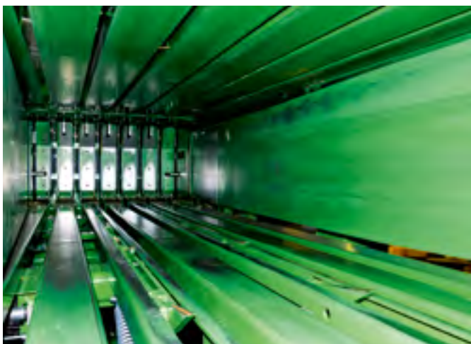
Le canal de pressage a été allongé d'environ 20% à 3,60 m de long. La paroi de compression supérieure s'étend sur toute la largeur.
