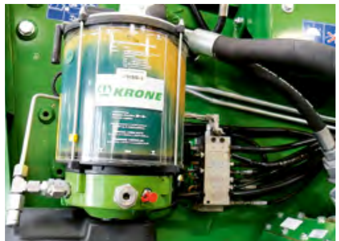
Grâce à une centrale de graissage de plus grandes dimensions, les intervalles d'entretien sont allongés.
