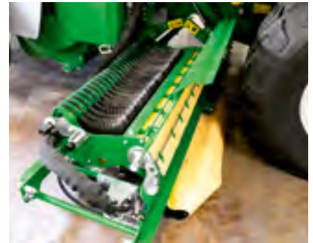
La tôle de nettoyage au-dessus des couteaux s'escamote facilement. L'unité de coupe à 51 couteaux dispose d'un système de nettoyage à air comprimé intégré.
